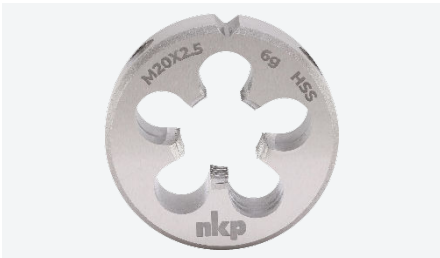
На торце плашки — маркировка резьбы, поля допуска и материала (M20x2,5 · 6g · HSS).
